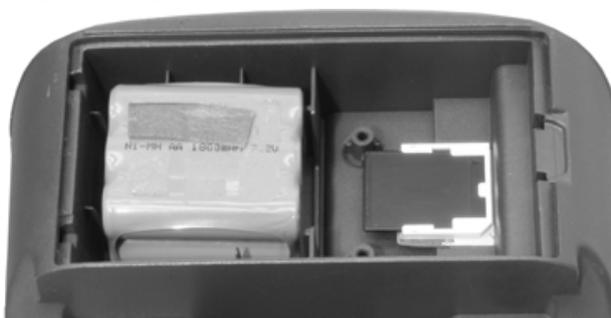
Un vano protetto da uno sportello bloccato da una clip, sempre nella base della macchina, alloggia il battery pack\* di 06 batterie ricaricabili da 1,2 Vdc 1200 mAh ed il dispositivo giornale di fondo elettronico.
