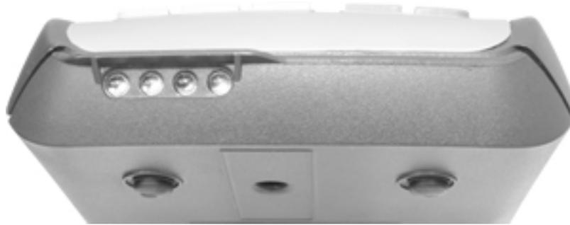
Nella parte anteriore del prodotto è inserita una linea di quattro speciali LED, che possono essere attivati dal tasto “CHECK” utilizzabili per la scansione delle banconote. Il fascio di luce U.V. generato, permetterà di controllare la presenza di ologrammi e di strisce d'argento all'interno della carta filigranata delle banconote, per il loro riconoscimento.
