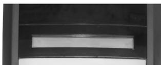
L'apparecchio è dotato di un indicatore da 16 digit tipo LCD alfanumerico, posizionato subito sopra alla tastiera. L'orientamento e la retro illuminazione dello stesso lo rendono visibile dall'operatore in qualsiasi condizione d'uso.
